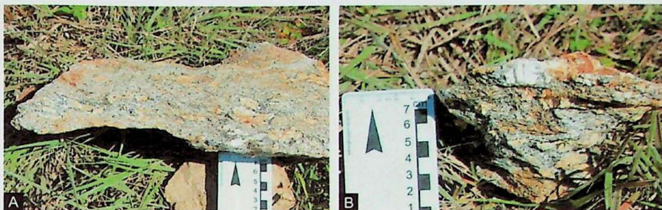
Figura 8. (A) Estrutura geral da rocha. (B) Detalhe para porfiroblasto centimétrico de plagioclásio.
